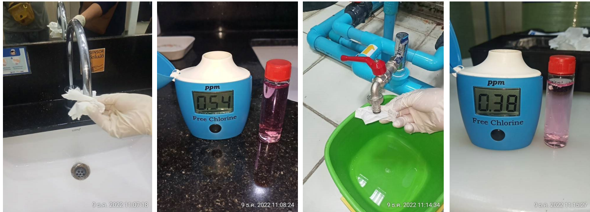
รูปที่ 2-20 การทำความสะอาดจุดก๊อกน้ำและวัดค่าน้ำ
